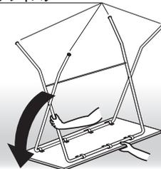
※ご使用時、脚パイプの接地が不安定な場合は脚パイプ端部のアジャスターを回してガタつきを抑えてください。
