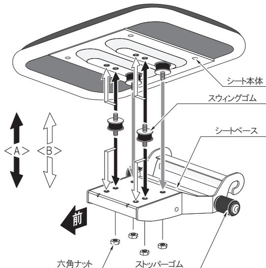
1. 座部裏の六角ナット 4個を外し(10mmスパナ推奨)シートベースを取り外します。この時スウィングゴムが空回りしないようプライヤーなどでスウィングゴムを挟んで固定して下さい。
