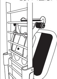
収納時図、シート裏の折り畳みフックを使用します。フックの引っ掛かりをよくご確認下さい。外れに設計されていますが持ち運びの際等はシートの落下にご注意して下さい。(イラストの製品はPW-600Sです)
